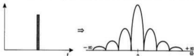
Рис.2. Спектральное разложение идеального импульса
