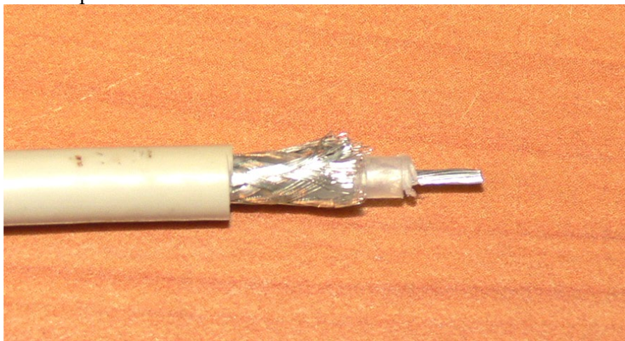
Рис. 2. Коаксиальный кабель RG-58 после зачистки
