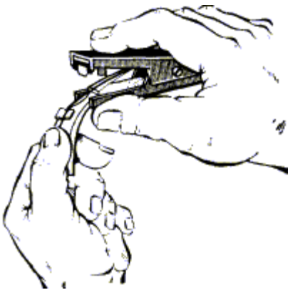
Рис.17. Скол оптического волокна Рис.18. Приспособление для скола волокон: 1 – лезвие ножа; 2 – держатель; 3 – лапка держателя; 4 – верхний рычаг; 5 – пластина
