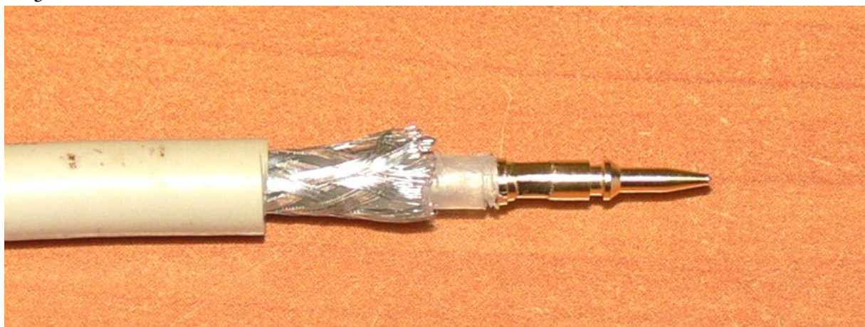
Рис.3. Коаксиальный кабель RG-58 после установки и обжима центрального контакта
