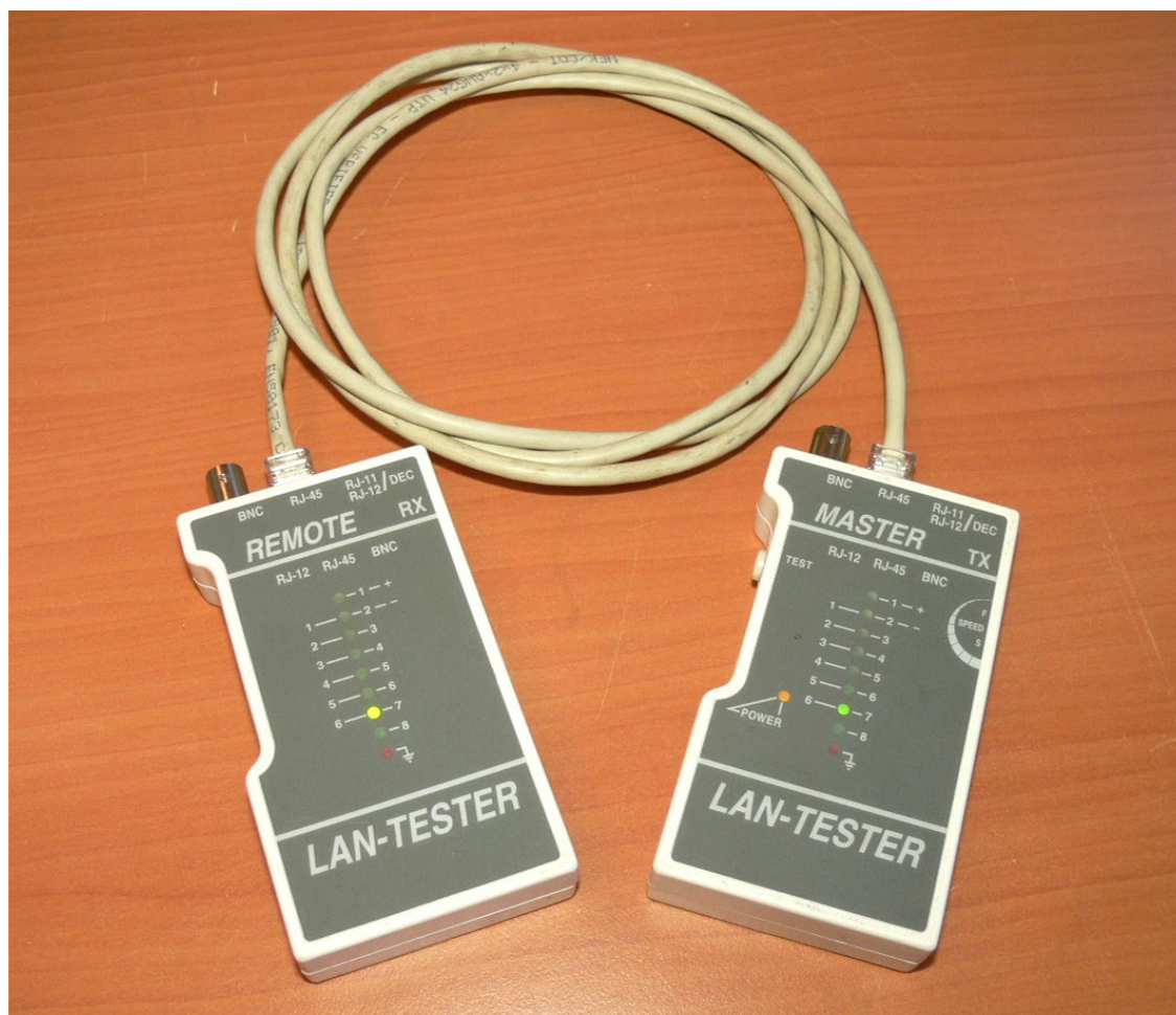
Рис. 10. Проверка качества заделки коннекторов RJ-45 с помощью специального тестера
