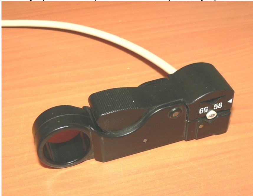
Рис. 1. Коаксиальный кабель RG-58 в устройстве для его зачистки
