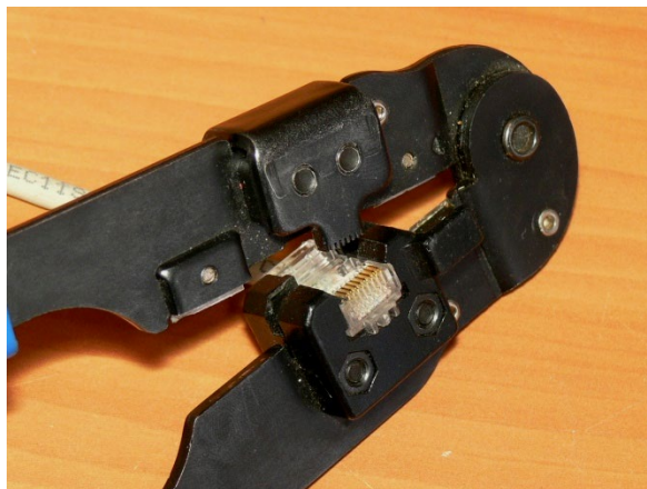
Рис. 9. Коннектор RJ-45 в обжимном инструменте
